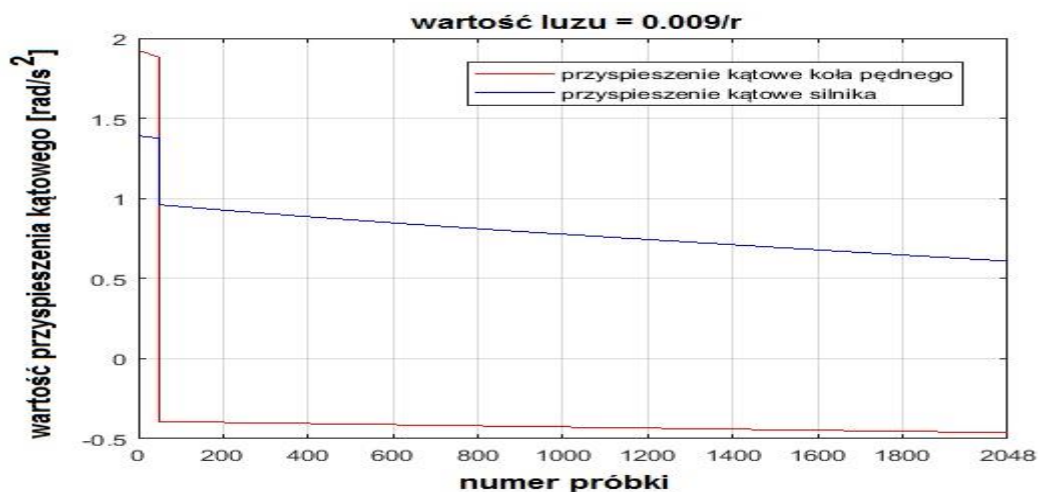
Rys. 3. Przebiegi porównawcze wartości zmiennych koła pędnego maszyny roboczej i silnika: kątów obrotu (a), prędkości kątowych (b) i przyspieszeń kątowych (c).
